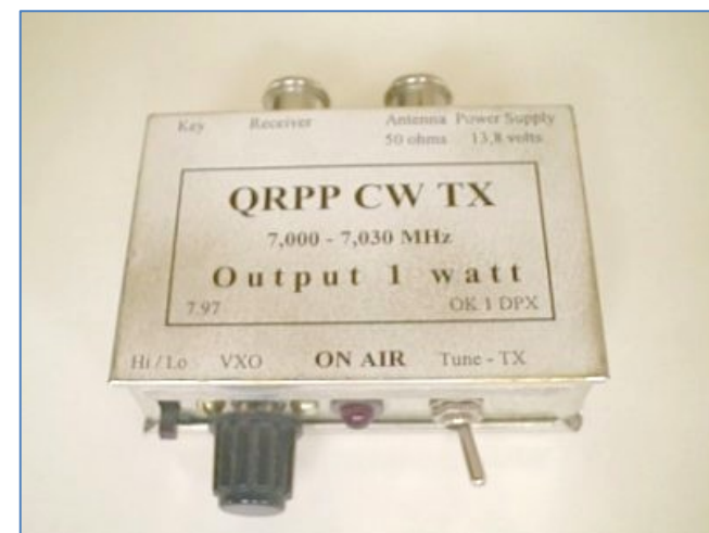
Plechová krabička má vnitřní rozměry 90x67x22 mm
